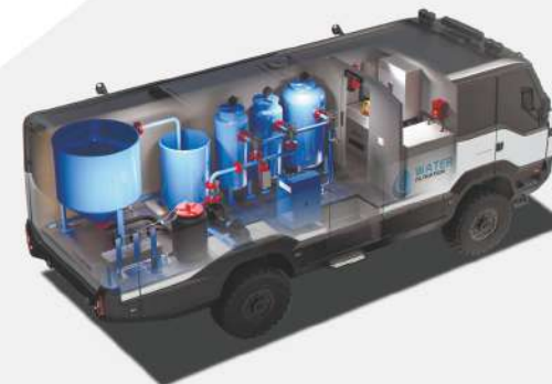
ФІЛЬТРУВАЛЬНА СТАНЦІЯ ДЛЯ ОЧИСТКИ ВОДИ
